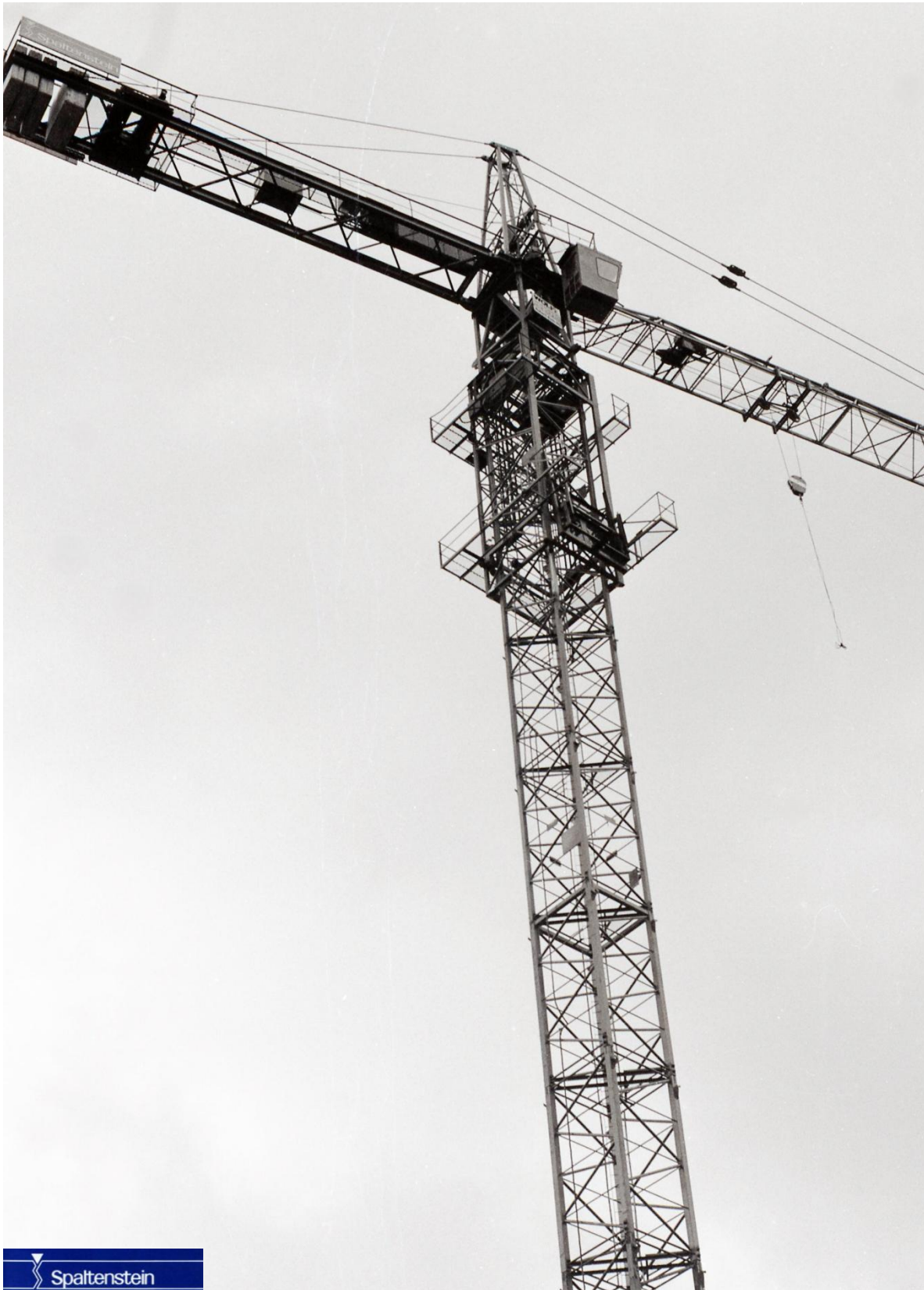
Wolff WK 120 SL der Firma Spaltenstein mit montiertem Kletterwerk. Foto Pius Meyer.
